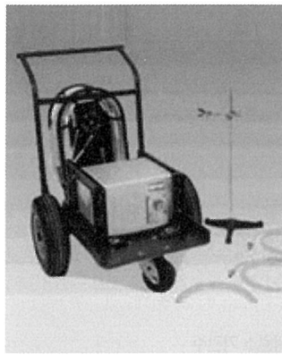
<그림 2> Cobalt-60 source projector
